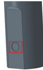
图 11 挡板凹坑损伤处理
