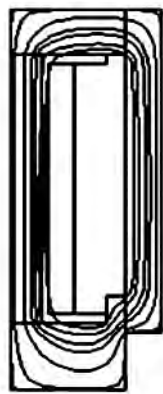
图 6 泵体磁力线分布情况
